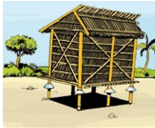
Crèche à maïs ventilée pour le séchage du maïs en épis (sans spathes). La structure a des murs en lattes et doit être placée avec le long mur faisant face au vent dominant.
